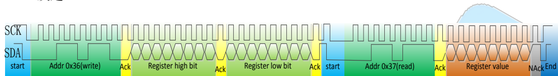
图 10 I2C 接口 slave 写时序图
